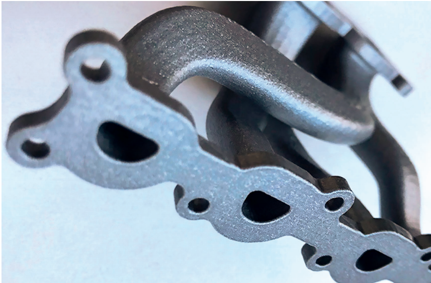
Vorteilhaft: Das chemische Glätten lässt sich sehr gut kontrollieren und ermöglicht reproduzierbare Ergebnisse bei gleichzeitiger Verbesserung der mechanischen Eigenschaften der 3D-gedruckten Bauteile. © Speedpart
